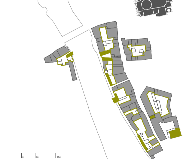
Ridefinizione delle corti, eliminazione delle superfetazioni, dei fabbricati incoerenti e di scarso valore, rigenerazione progressiva del costruito, integrazione/sostituzione di volumi di natura semi-pubblica.
