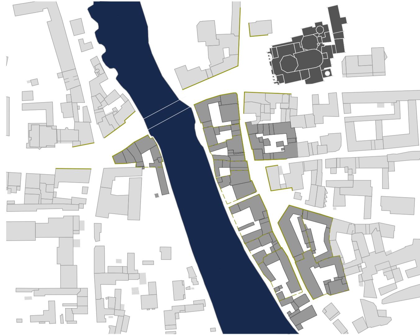
SERIATE - TESSUTO CAMPIONE DEL CENTRO STORICO - scala 1:2000 Definizione dell'ambito di progetto e lettura morfologica delle cortine stradali e dell'impianto a corti.
